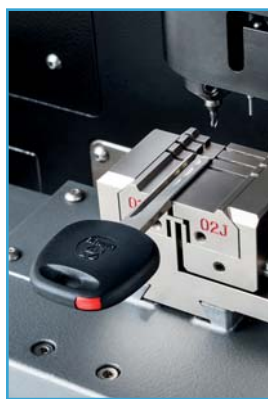
Taillage d'une clé laser
