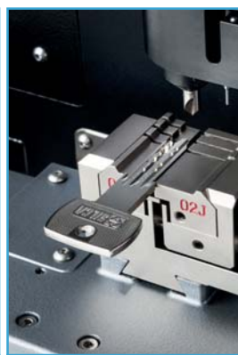
Taillage d'une clé à points
