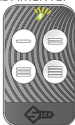
**8-** SIMULTÁNEAMENTE, APRETAR LOS DOS BOTONES 1 Y 2 EN EL MANDO BFT Y SOLTAR INMEDIATAMENTE HASTA QUE EL LED EMPIECE A PARPADEAR (TRANSMISIÓN DE CÓDIGO FUENTE).
